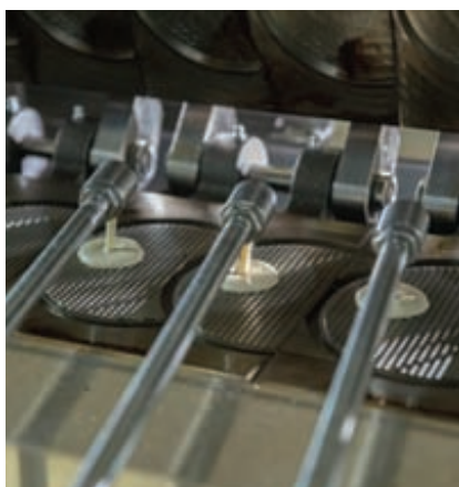
Der Formprozess einer typischen Waffel – in dem Fall von Eistüten: Der Teig wird auf einzelne Backplatten aufgegossen, welche mit bis zu 0,5 m/s durch den Ofen zirkulieren. Am Ende wird die Waffel zu einem Stanitzel gedreht.
