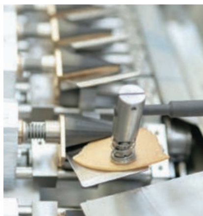
Der Formprozess einer typischen Waffel – in dem Fall von Eistüten: Der Teig wird auf einzelne Backplatten aufgegossen, welche mit bis zu 0,5 m/s durch den Ofen zirkulieren. Am Ende wird die Waffel zu einem Stanitzel gedreht.
